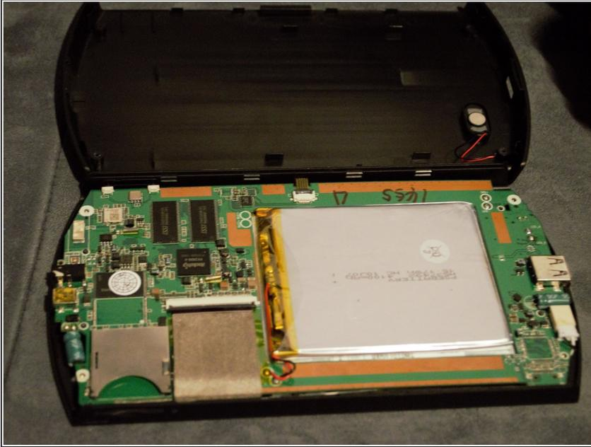
**!** Die Lötunkte des Lautsprechers an der Rückseite lösen sich leicht ab.
