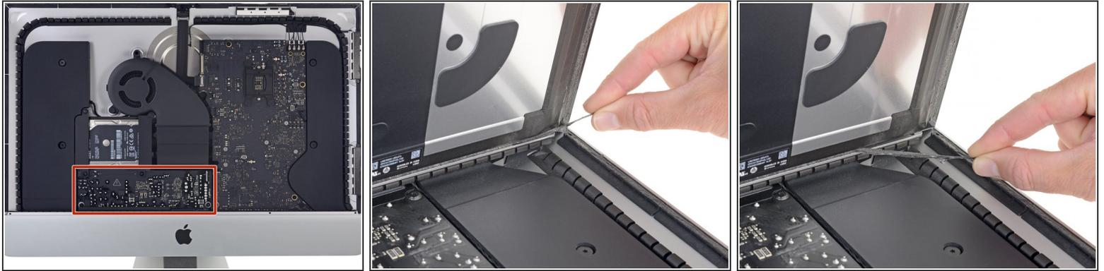
**⚠ 必要に応じて、プラスチックカードを使って底側の接着剤ストリップを切開できます。**
