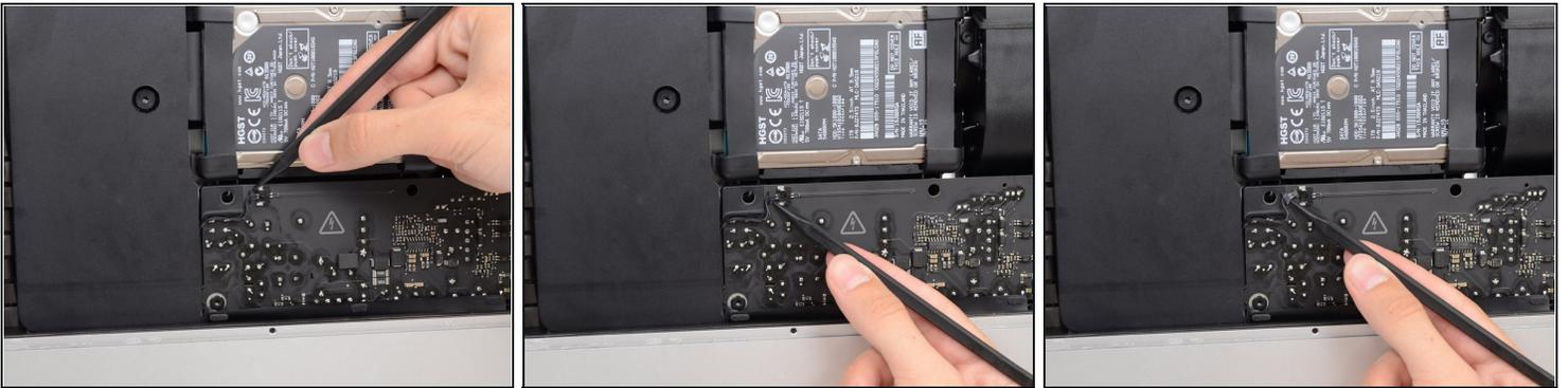
⚠ Dans les étapes suivantes, vous serez amené à travailler près de la surface à découvert du bloc d'alimentation. **Évitez** tout contact avec la surface du bloc d'alimentation. Les nombreux condensateurs soumis à une tension élevée présents sur la carte pourraient provoquer une décharge électrique.
