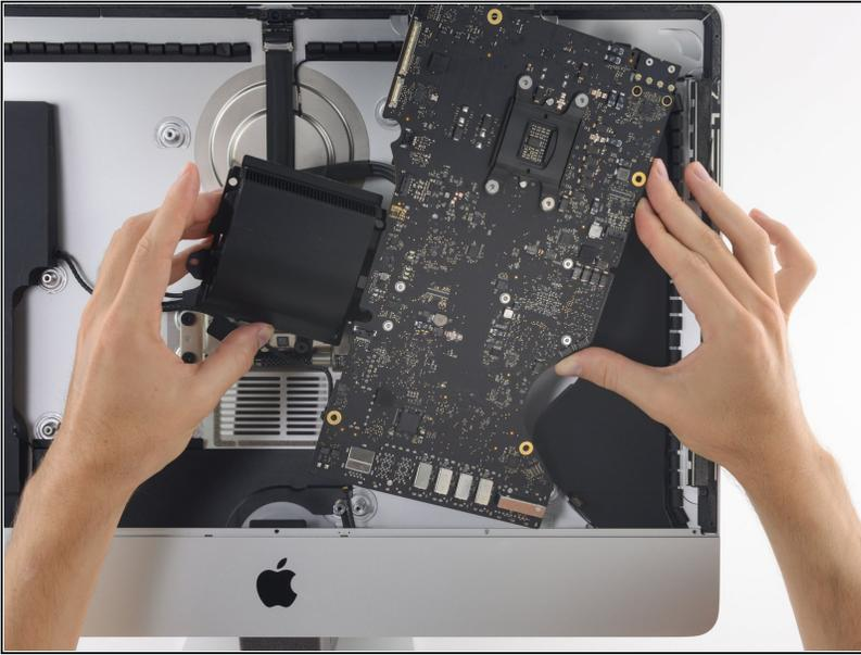
⚠ Al retirar e instalar la placa lógica, tenga cuidado de no dañar el delicado [cable plano del micrófono](#) en la parte inferior izquierda.
