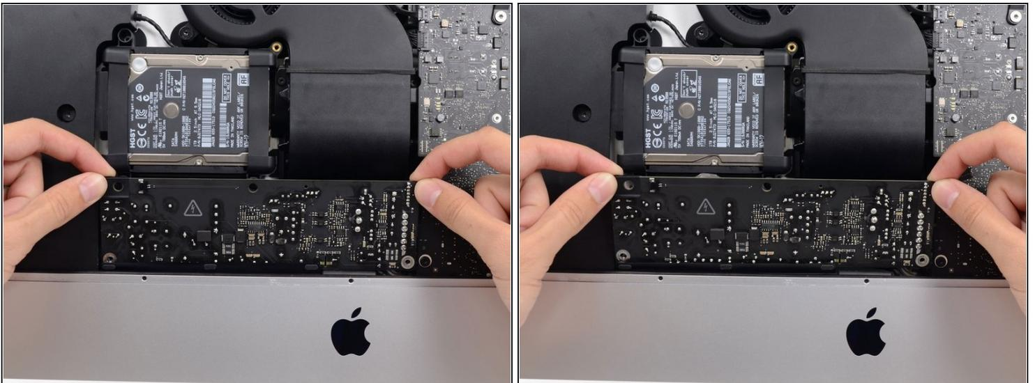
**⚠** Cuando trabajes en la fuente de alimentación, ten mucho cuidado de no tocar los cables del condensador o cualquier junta de soldadura expuesta en la parte posterior de la fuente de alimentación. Solo maneja el tablero por los bordes.
