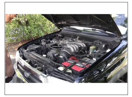
• <u>After removing the</u> bolts on the fan and fan cover, take out the fan cover and fan .
