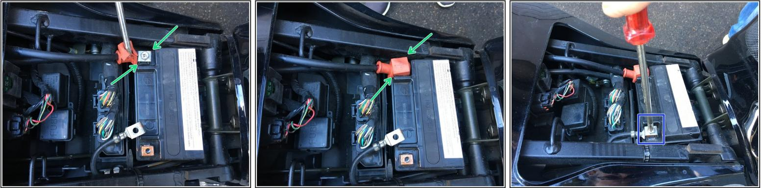
⚠ Bevor die Batterie wieder angeschlossen werden kann müssen sämtliche Stromverbraucher (Licht, Zündung, etc.) abgeschaltet sein.
