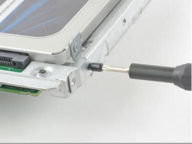
Montiere die Haltestifte der alten Festplatte mithilfe eines T8 Schraubendrehers auf die Seiten des Einschub.
