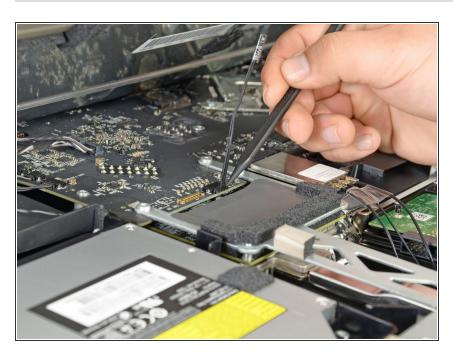
Löse die Stromversorgung des Displays neben dem Datenkabels mit der Spudgerspitze.
