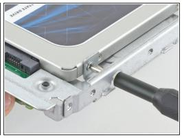
Benutze einen Kreuzschlitzschraubendreher, um die vier silbernen Schrauben (zwei auf jeder Seite) an den Kanten der SSD einzusetzen, um sie am Einschub zu befestigen.
