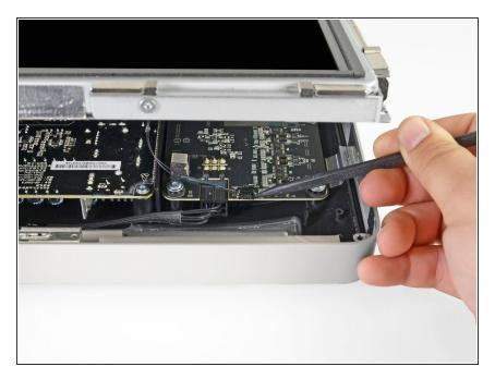
Löse das Kabel für die Vertikalsynchronisierung in der oberen linken oberen Ecke des Bildschirms. Drücke mit der Spudgerspitze auf die Seitenlaschen des Verbinders und lasse diesen so ganz vorsichtig aus seinem Anschluss heraus wandern.
