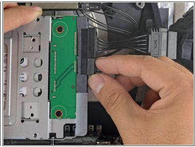
Verbinde das SATA-Datenkabel des iMacs mit dem Einschub.
