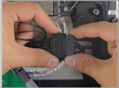
Verbinde das SATA-Netzkabel des iMacs mit dem anderen Ende des neuen sensoraktiven SATA-Kabels.
