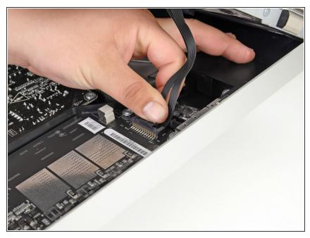
In diesem Schritt gelangen deine Hände in die Nähe der offenliegenden Rückseite der Stromversorgung. Berühre **nie** die Rückseite der Stromversorgung, die vielen großen Kondensatoren können heftige und gefährliche Stromschläge austeilen.
