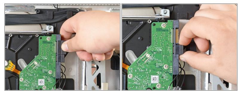
Löse das SATA Versorgungskabel und SATA Datenkabel, indem du sie gerade von der Festplatte abziehst.
