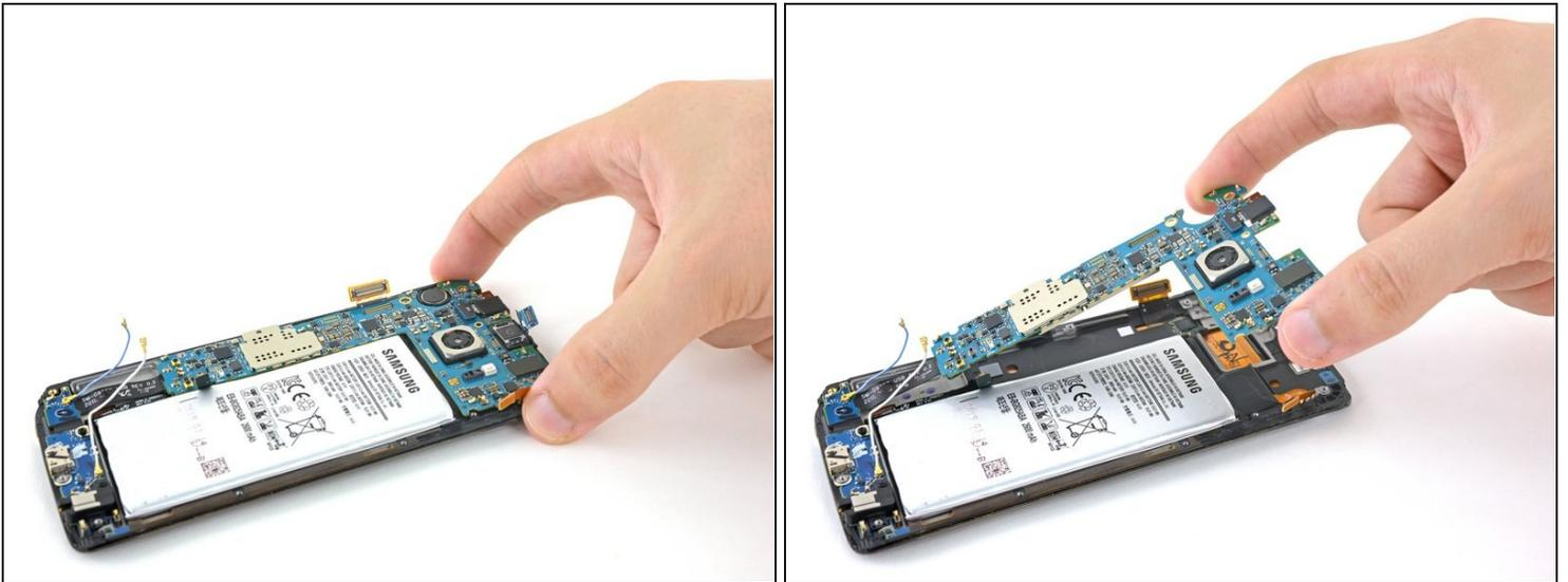
**⚠** Das Motherboard ist eine ESD empfindliche Komponente und sollte mit Vorsicht behandelt werden. iFixit empfiehlt immer ein anti-statisches Armband zu tragen, wenn man mit Komponenten dieser Art arbeitet um Schäden zu vermeiden.
