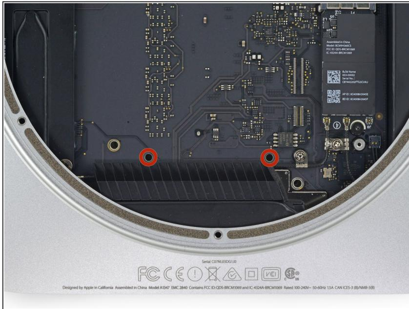
**⚠** Para extraer la placa lógica, las dos varillas cilíndricas de la herramienta de extracción Mac mini Logic Board deben insertarse en los orificios resaltados en rojo. Insertar instrumentos en cualquier orificio de la placa lógica que no sean los resaltados en rojo puede destruir la placa lógica.
