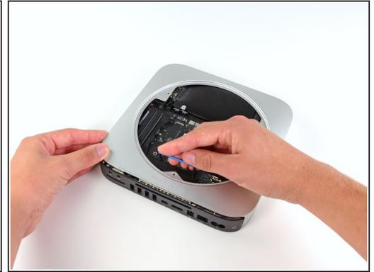
**i** Um genug Freiraum für das Entfernen der Festplatte zu haben, muss das Logic Board ein Stück weit verschoben werden. Dazu müsste zwei zylindrische Stäbchen in die rot markierten Löcher eingesetzt werden.
