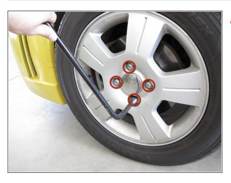
Use a 19 mm lug wrench to loosen each lug nut a half turn.
