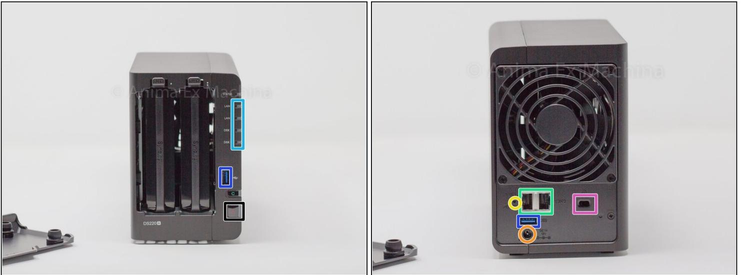
❗ Voici les différentes faces intéressantes du boîtier : avant (baie disques, LEDs), arrière (connectique et ventilateurs).
