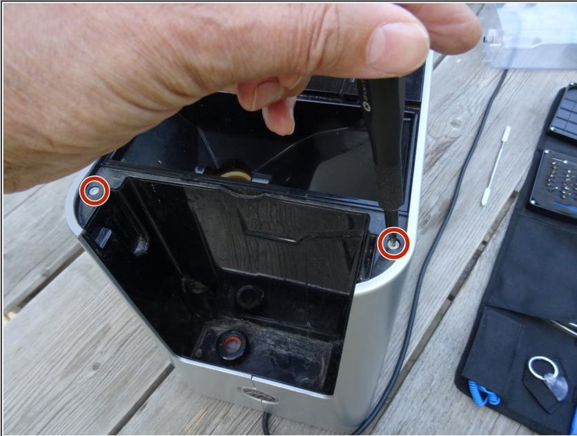
ⓘ Die Seitenteile werden nach hinten herausgeschoben. Sie sind allerdings oben mit zwei Schrauben und einer Verriegelung, an den Seiten mit einer keilförmigen Raste gesichert.
