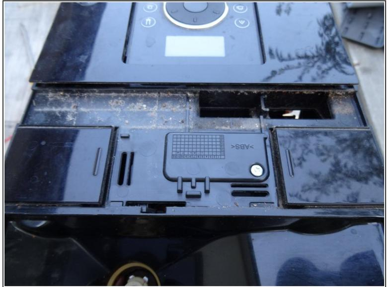
**i** Die oberen Abdeckungen müssen nicht unbedingt für alle Reparaturen ausgebaut werden. Für eine gründliche Reinigung ist es jedoch unverzichtbar. Eventuell lassen sich die oberen Abdeckungen leichter lösen, wenn die Seitenteile zuerst entfernt werden. Der Vorgang ist insgesamt etwas knifflig.
