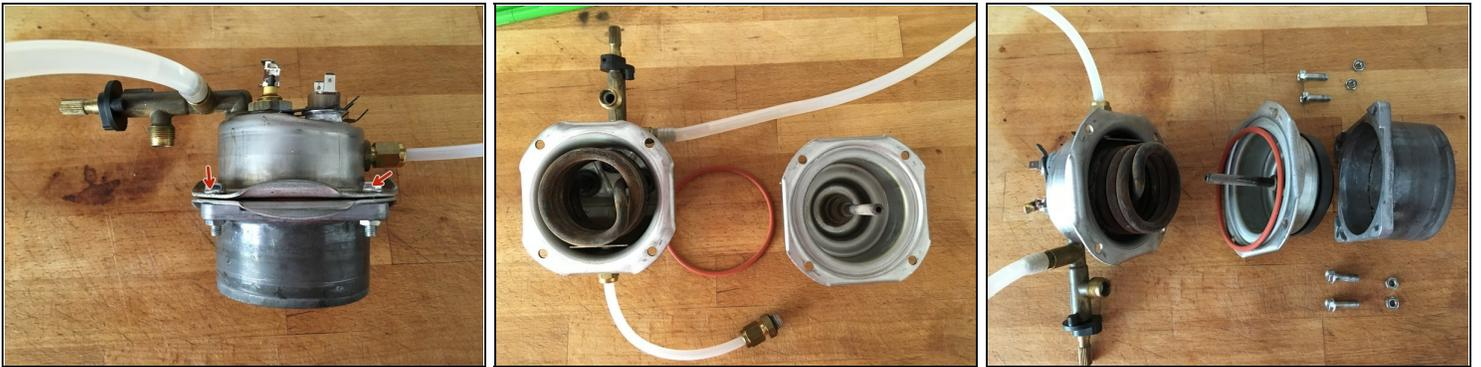
**⚠ Die vier Schrauben lösen - Vorsicht es läuft Wasser aus. Schlüsselweite 8**
