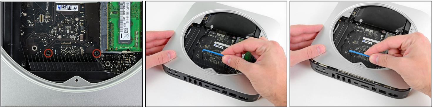
**⚠** Um die Hauptplatine zu entfernen, müssen die beiden zylindrischen Spitzen des Mac Mini Logic Board Removal Tools in die rot markierten Löcher eingeführt werden. Wenn du sie in andere Löcher auf der Platine einführst, kannst du die Hauptplatine eventuell beschädigen.
